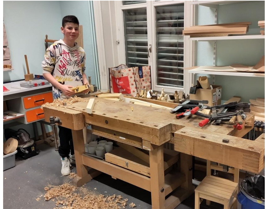
Planhobeln einer Vollholzplatte von Hand
